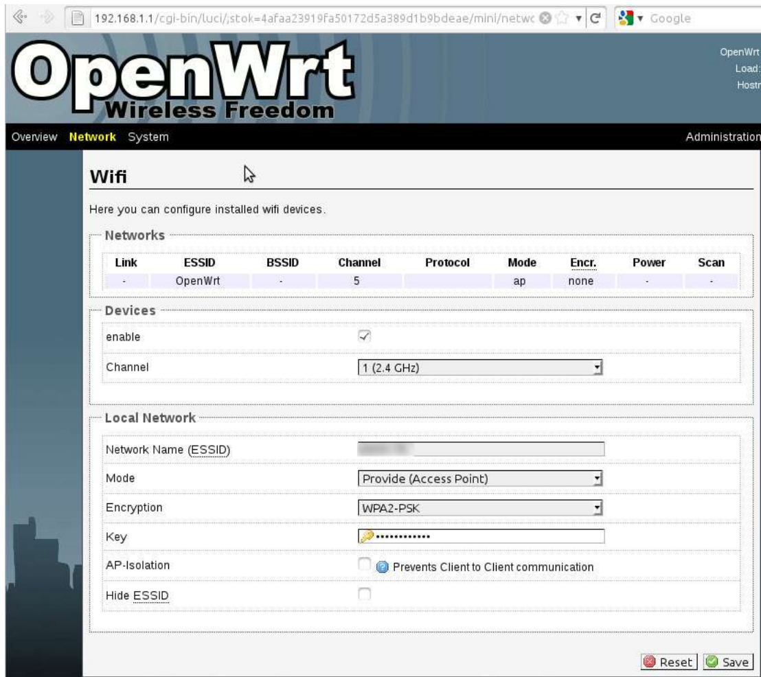
Рис. 18. Настройки беспроводного сетевого интерфейса WiFi-маршрутизатора и установка пароля на доступ к радиосоте
