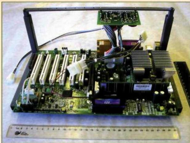
Рис. 2. ПК-маршрутизатор без механически подвижных частей с низким энергопотреблением
