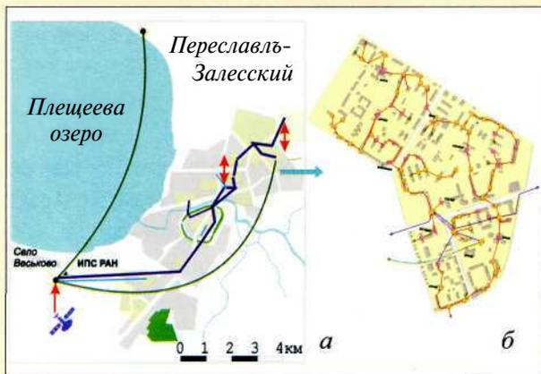
Рис. 1. Модернизированная оптическая магистраль СТ «Ботик» (а) и пример покрытия микрорайона (б)
