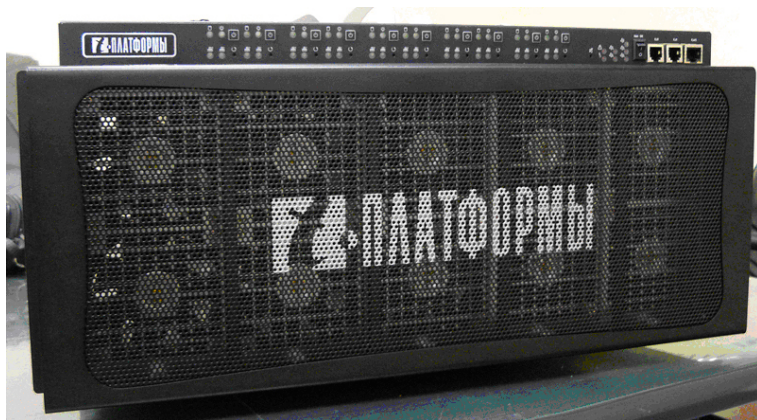
Рис. 6. Первое российское blade-решение — модуль для суперкомпьютера «СКИФ МГУ» (разработка и производство компании «Т-Платформы»)
