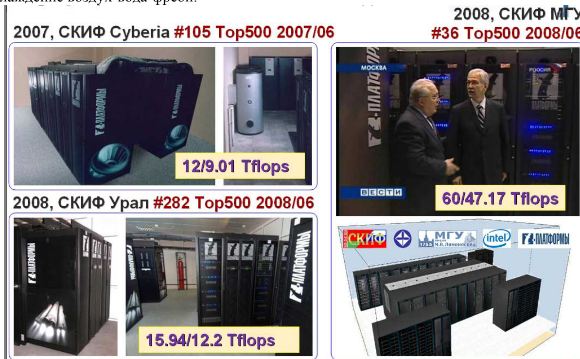
Рис. 3. Некоторые модели суперЭВМ семейства «СКИФ» Ряда 3 Конструкторская документация и опытные образцы Ряда 4 суперЭВМ семейства «СКИФ» запланированы к разработке в 2009—2011 гг. Данные суперЭВМ будут иметь производительность 500—5 000 Tflops. В качестве системной сети в них будет использована отечественная системная сеть (3D-тор на базе FPGA), а в качестве вспомогательной сети — Infiniband QDR или 10Gb Ethernet. Еще больше повысится плотность упаковки вычислительной мощности. Будут использоваться новые отечественные blade-системы, которые позволяют упаковать 32 вычислительных узла в шасси 6U. Плотность упаковки — более 10 CPU на 1U. Такая высокая плотность упаковки потребует совершенно новых подходов к охлаждению вычислительной установки. Поэтому разрабатывается система непосредственного водяного охлаждения вычислительных узлов. В рамках семейства «СКИФ» Ряда 4 должно быть предусмотрено широкое использование спецпроцессоров и ускорителей, построенных на разных аппаратных решениях.
