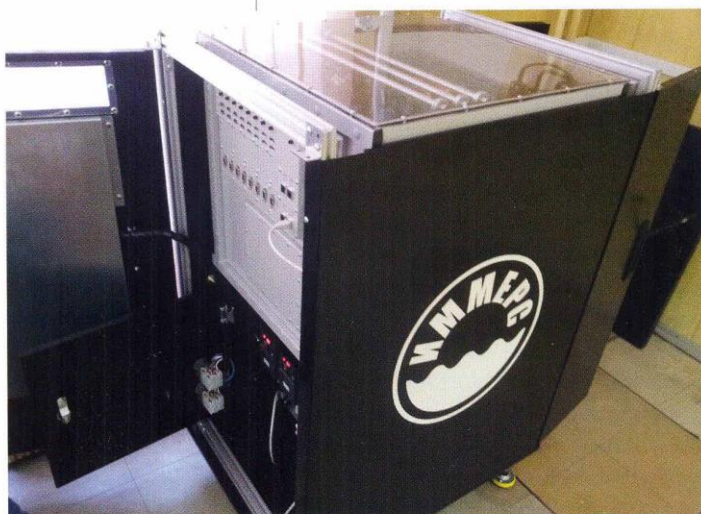
Рис. 2. Вычислительный комплекс IMMERS 8 R5 с погружной системой охлаждения
