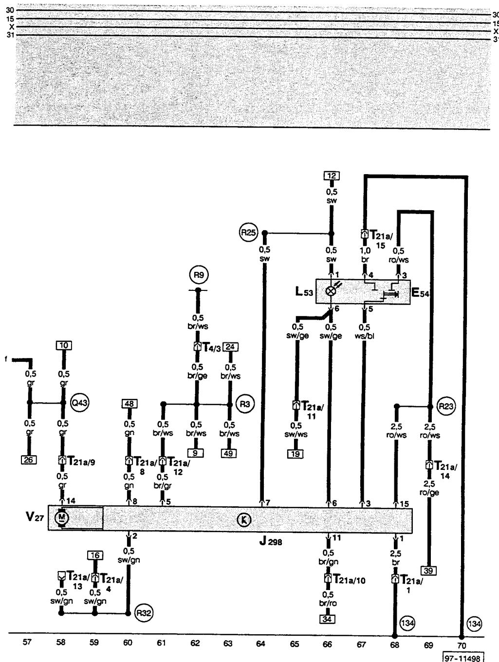
E 54 - выключатель стеклоподъемника сзади справа
