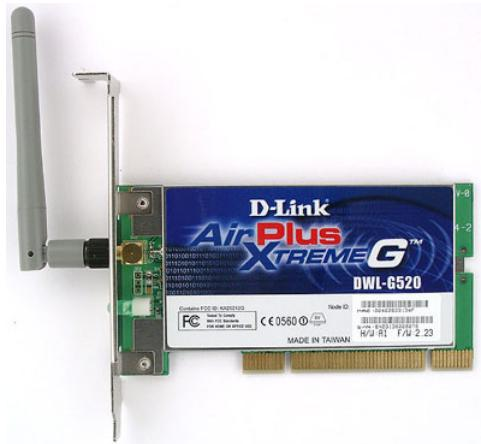
Рис. 1.2: Адаптер беспроводной связи D-Link DWL-G520
