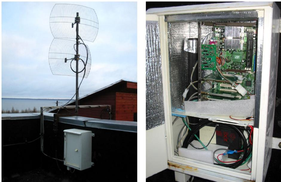
Рис. 1.9: Магистральный узел в термобоксе на крыше ИПС РАН
