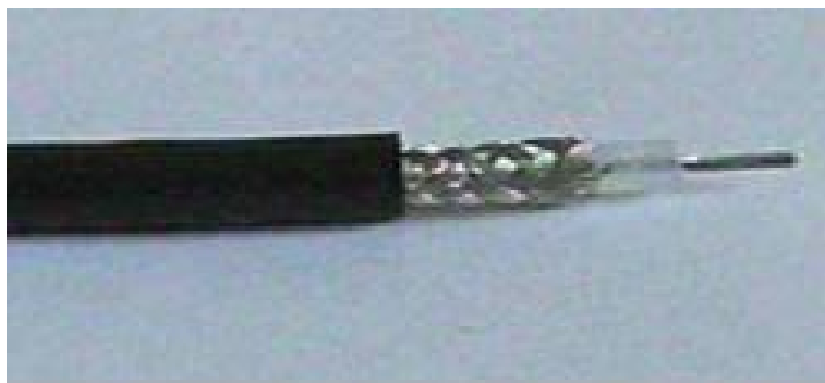
Рис. 13. Коаксиальный кабель, подготовленный для соединения с разъемом
