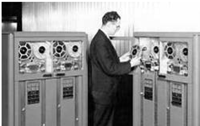
Рис. 5. Магнитофон для записи данных фирмы IBM, плотность записи: 100 бит на дюйм, длина ленты на бобине: 1200 футов, 1953 год
