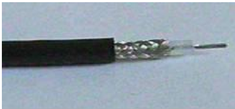
Рис. 13. Коаксиальный кабель, подготовленный для соединения с разъемом
