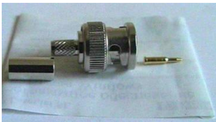
Рис. 13. Коаксиальный кабель, подготовленный для соединения с разъемом
