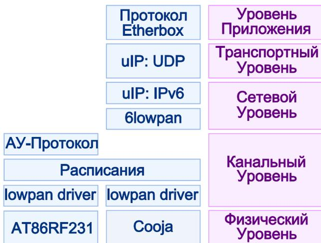
Рис. 2. Сетевой стек узла
