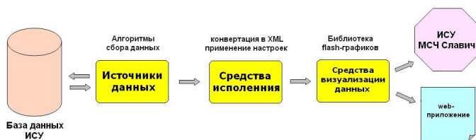
Рис. 1. Структура и схема работы «АРМ руководителя» в ИСУ МСЧ Славич
